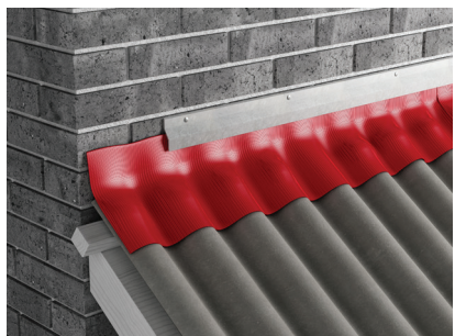
rys.44. Wykończenie styku połączenia dachowej ze ścianą.
