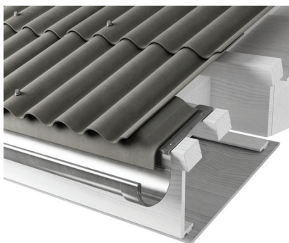
rys.48. Okap / pas nadrynnowy wykonany z włókno-cementu.
